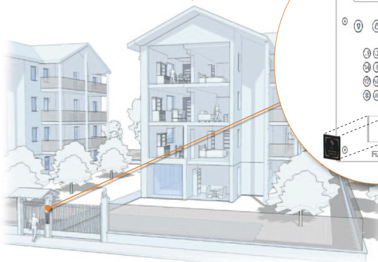
Se širokou paletou čteček, připojenou ke kontroléru pouze pomocí dvou vodičů, se může Easy Door Controller stát nenápadnou součástí i vaší budovy.
