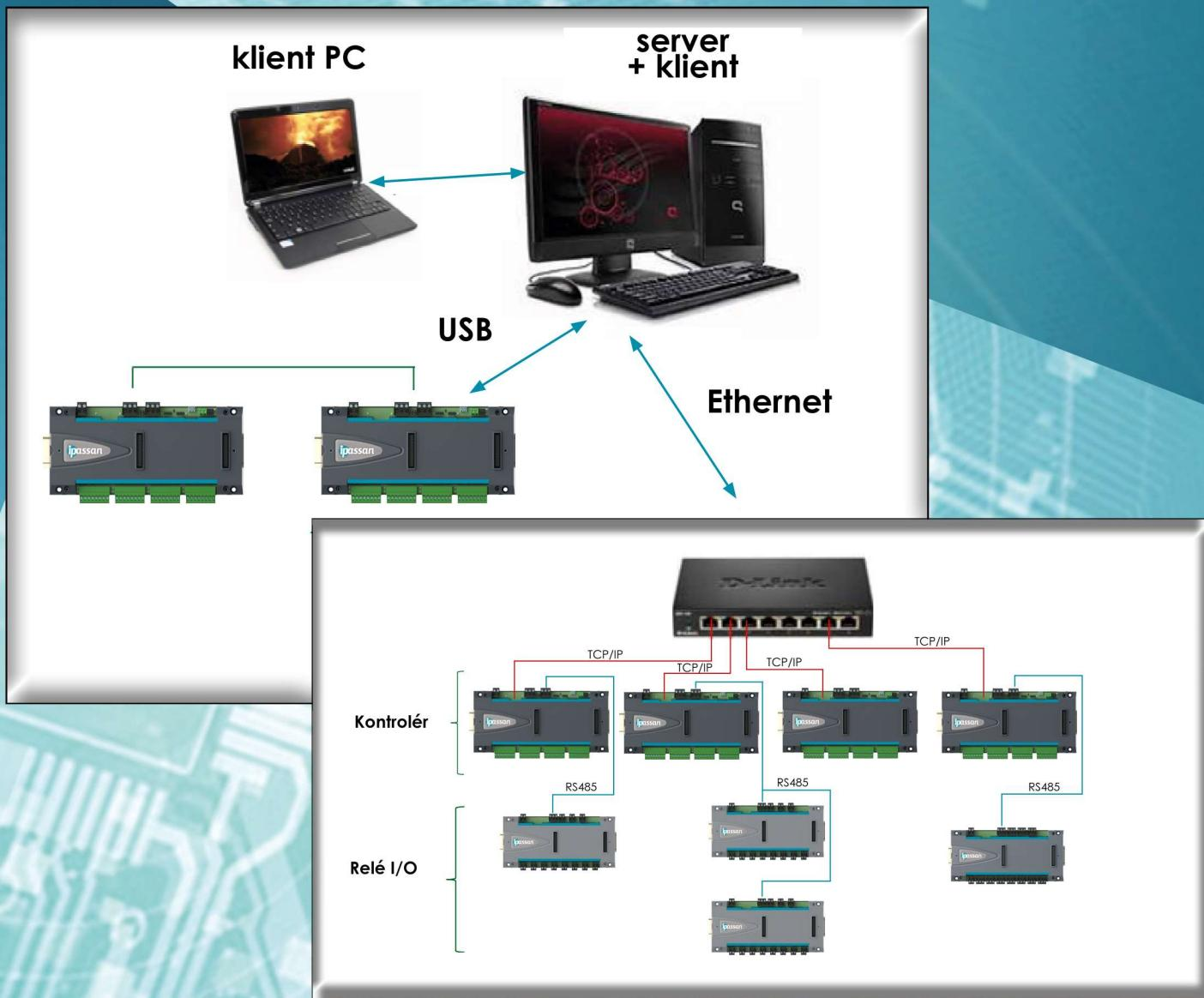
**IPassan** je možno instalovat prakticky v jakékoliv budově. Dvě komunikační technologie vám dávají na volnost výběru výhodnější varianty. Šifrovaná sběrnice **FDI RS485** přináší výhody jednoduché a odolné sběrnice: jednoduchá na instalaci, spolehlivá, umožňující pohodlný provoz. Je tvořena pouze třemi vodiči. Správný chod sběrnice je indikován signalizačními LED.
